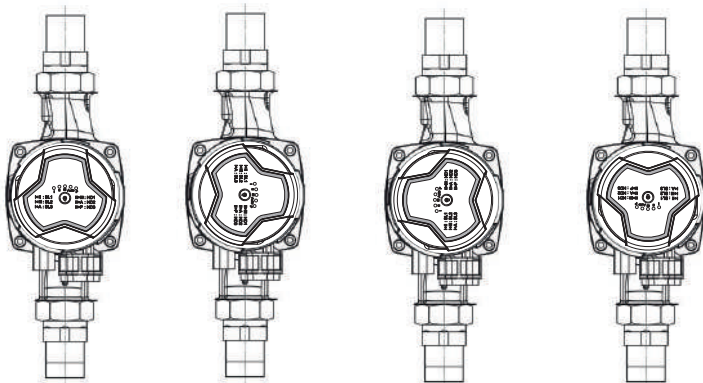
Рис. 5 Расположение головной части насоса
